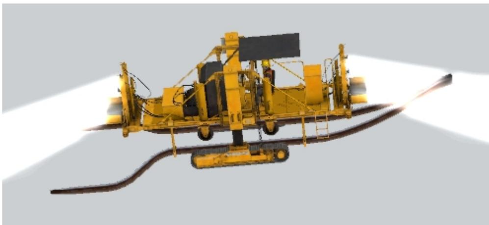
Ces deux engins travaillent de pair pour le déchargement et la dépose le long des remblais des rails en vue de préparer le terrain pour la prochaine machine.
